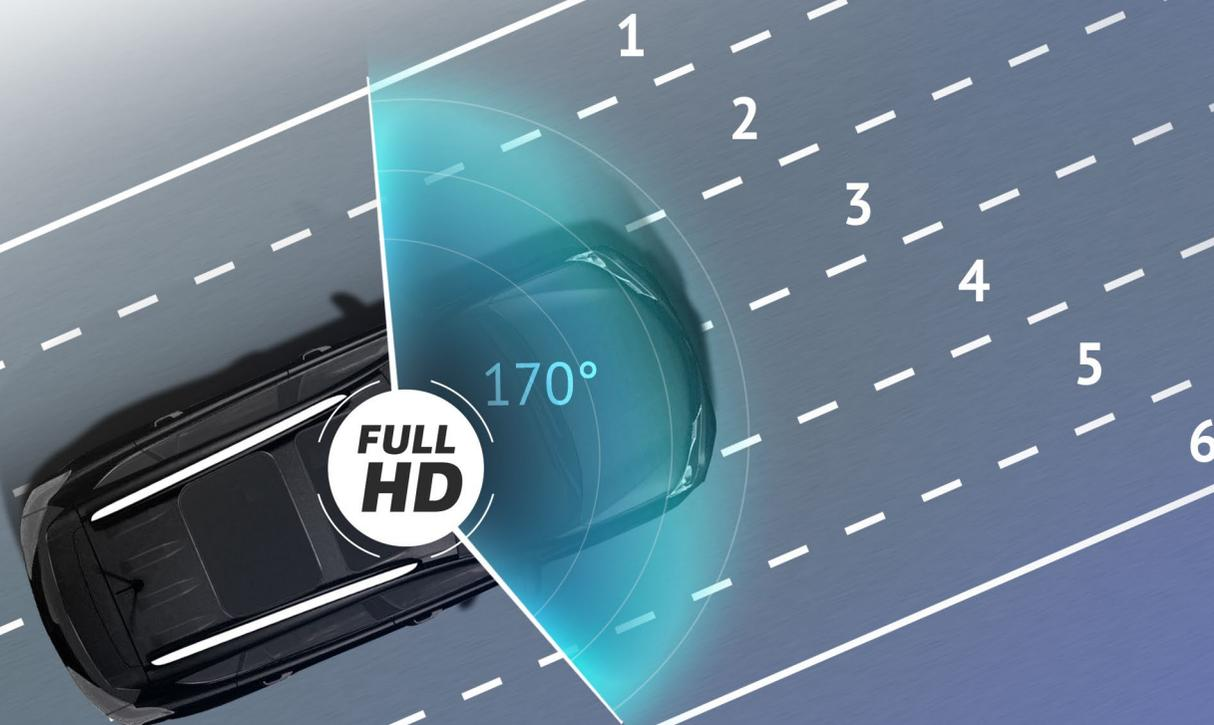
Мощный процессор **Jieli JL5603** обеспечивает детализированную съемку в **Full HD** разрешении. Обработка видео ведется с применением **кодека H.264**, что позволяет хранить значительно больше видеофайлов на SD карте. Благодаря углу обзора **170 градусов** в кадр попадает шесть полос дорожного полотна и обочина.
